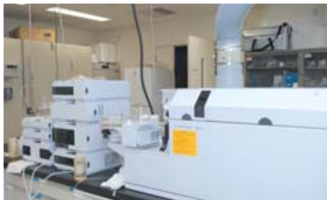
化学物質を分析するためのHPLC/ICP-MS。最新のこの機器では、1日におよそ10検体の分析、測定が可能
