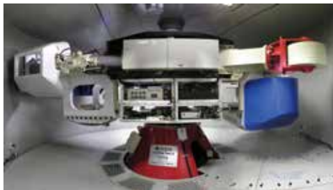
地盤の崩壊実験に使用する遠心力載荷装置
