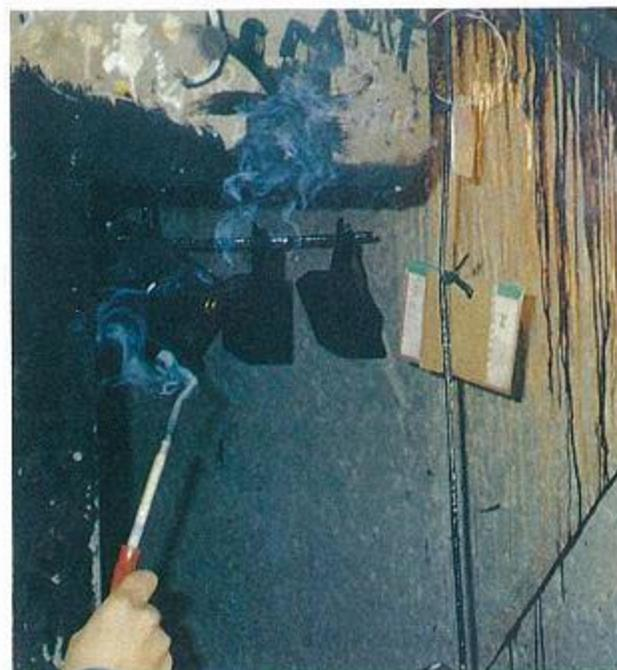
写真3 局所排気装置の吸引性能検査
