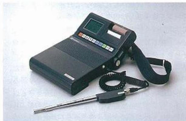
写真1 熱式微風速計の一例
