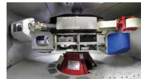
地盤の崩壊実験に使用する遠心力荷重装置
