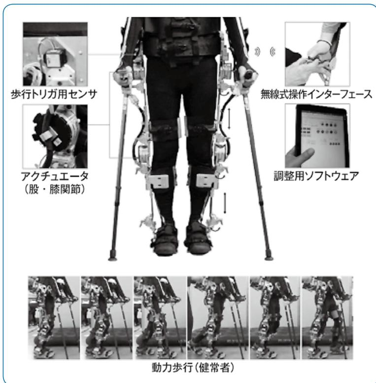
健常者を対象とした予備調査によれば、下肢に沿わせるようにフレームを配置することが可能となり、各部調整機能の有効性が確認された。また、標準体型の健常者が装着して、立ち上がり、歩行、着座モードを実行することができた。さらに、無線式操作インターフェース (押しボタン) により遠隔操作が可能となり、装着者自身による動作モードの切り換え、停止操作が可能となった。今後、軽量化を含めたプロトタイプの改良と評価実験を行い、安全性と使用性についてさらに調べる予定である。
