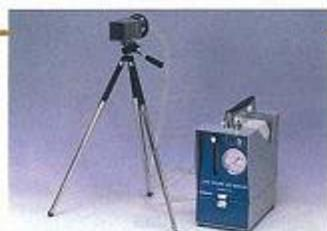
写真1 ローボリュームエアサンブラーおよび多段分粒装置
