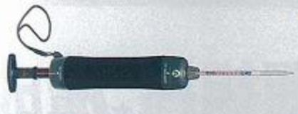
写真1 ガス採取器
