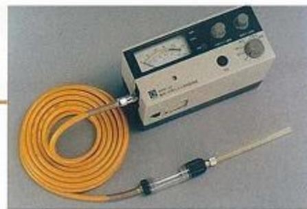
写真3 吸引式酸素・可燃性ガス検知警報器
