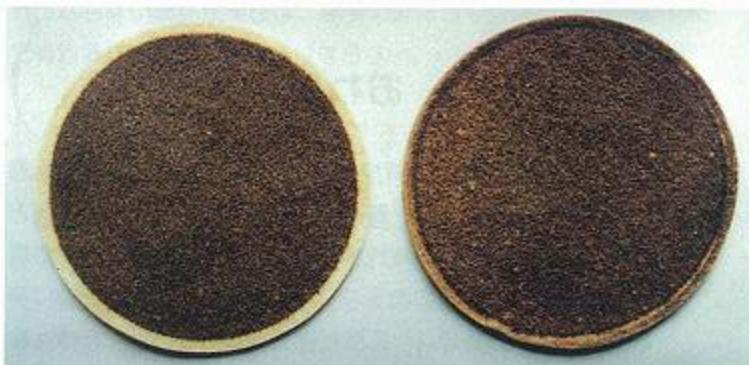
写真2 ろ過材の固定不良の例（電気溶接作業）
