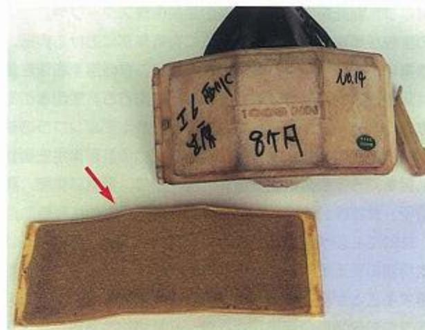
写真1 ろ過材の固定の良・不良の例（電気溶接作業）
