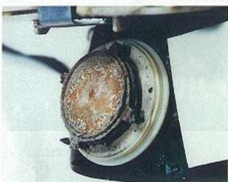
写真6 排気弁に金属片がはさまっている（電気溶接作業）
