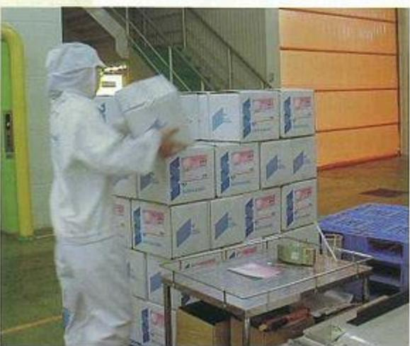
ンボール箱に梱包された製品を規定のパレット上に積み上げる際、パレットが大きいこともあり、箱を持って移動する距離が長くなってしまい、腰への負担や移動による疲労、運搬作業時間のロスといった点から、その改善が必要となった（写真2～4）。
