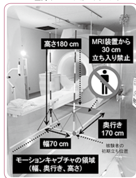
図2. 立ち入り制限区域の設定とMRI室内でのモーションキャプチャ
