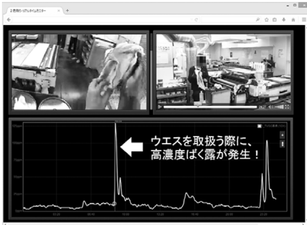
図. ビデオばく露モニタリングシステムによる測定例 (印刷業)
