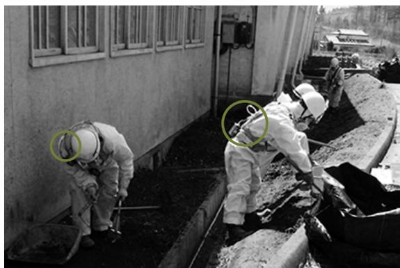
写真1. 除染作業における現場調査、○印は作業員の体に付けた粉じん計
