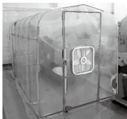
写真1. 実験用に試作した漏洩煙抑制機能付きの喫煙室
