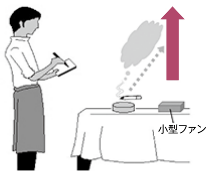
図1. 上に向けた卓上の小型ファンで送風を行い副流煙を上昇気流側に導いて、従業員側への拡散を抑制する
