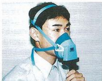
写真1 フィルターが1つの例（吸引口にフィットチェッカーを取り付ける）
