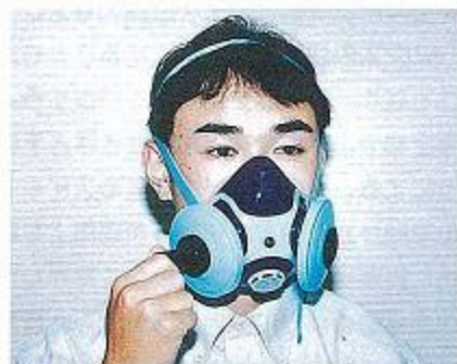
写真2 フィルターが2つの例（一方の吸引口にフィットチェッカーを取り付け他の一方は栓でふさぐ）
