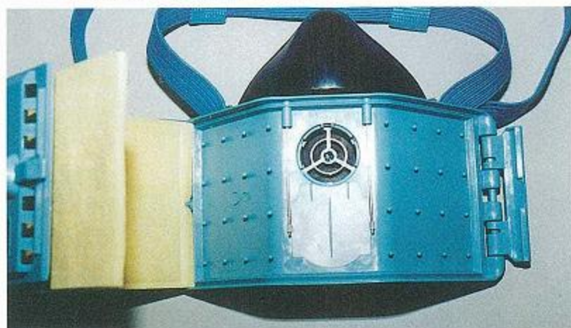
写真5 レバーを引き上げると吸気口をプラスチックの板で塞ぐ（写真3の状態）。フィットのチェックができる。チェックが終わったらレバーを下に下げ、そのまま作業することが可能。
